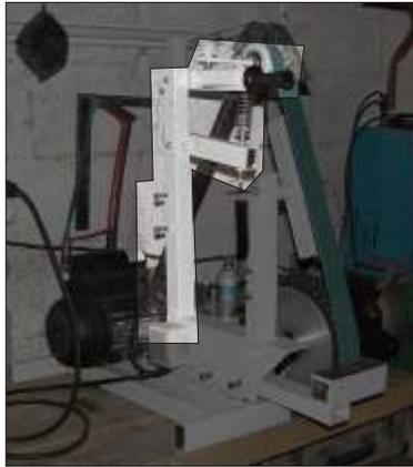
Et on positionne l'ensemble sur la base avec le moteur et la roue de contact. Comme précédemment, il faut bien prendre garde à l'alignement :
