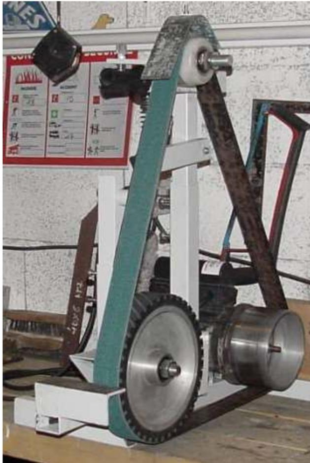
Pour des nécessités de coutellerie amateur, j'ai eu besoin de construire un backstand. Un backstand est une ponceuse à bande stationnaire. Cette construction est une construction amateur, faite à partie d'éléments de récupération. J'ai groupé les dimensions des tubes pour simplifier la liste des courses :-> c'est pourquoi les sections données diffèrent un peu des photos.
